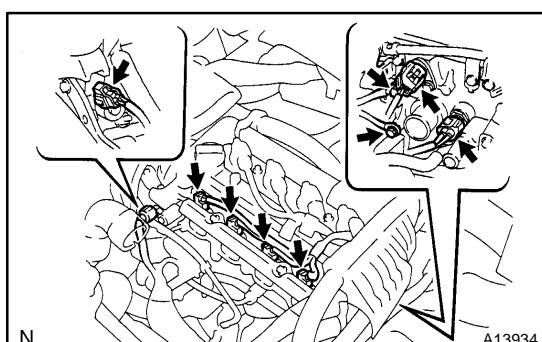
11. DISCONNECT ENGINE WIRE FROM CYLINDER HEAD
